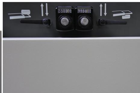
Les déplacements se trouvent au front de la machine et sont jusqu'à 0.1 mm réglables.
